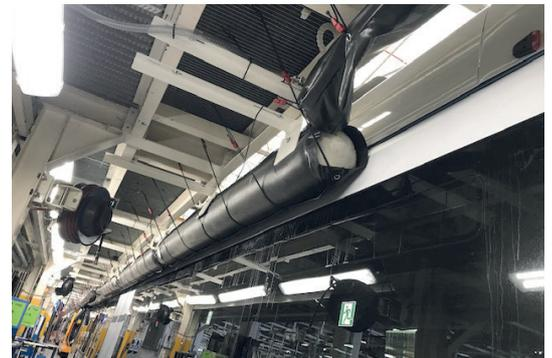
De part la structure même du gonflable le module comblera l'espace disponible quelque soit sa dimension. Le véhicule est à l'abri de tout dommage grâce à l'utilisation de faible pression.
